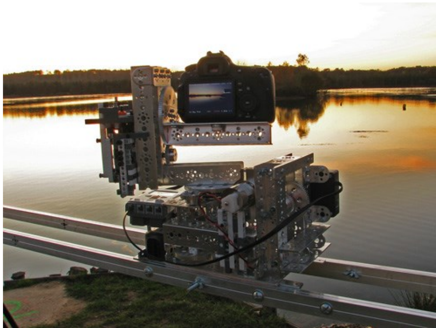
Stop motion felvétel. Kockánként továbbmozduló kameramozgató szerkezet
